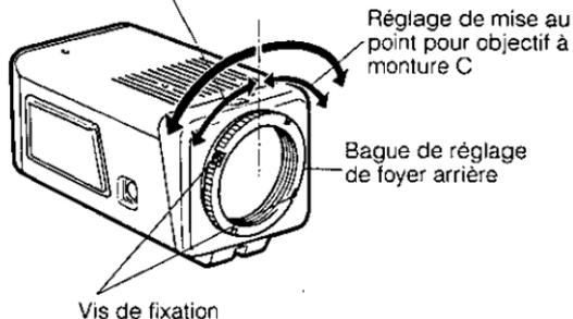
2. Tourner la bague de réglage de foyer arrière sur la position désirée.
