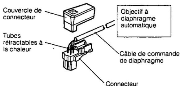
**Remarque:** Couper la nervure du connecteur si le câble de commande de diaphragme est trop épais sinon l'interconnexion du couvercle de connecteur et du connecteur ne peut pas être assurée.
