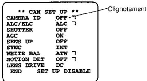
Le menu CAM SET UP apparaît sur l'écran du moniteur vidéo sous la forme représentée sur la figure ci-dessus.
